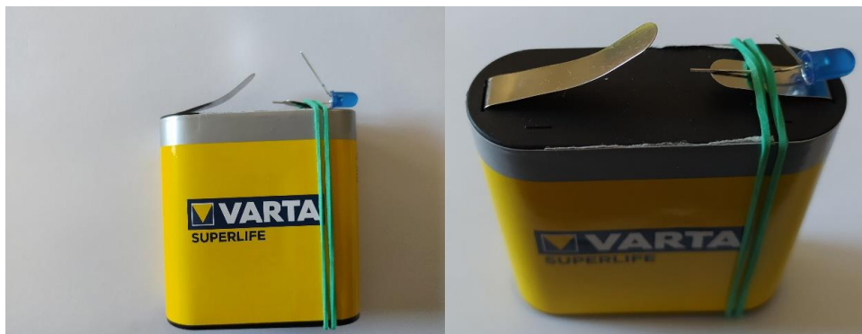
Obrázok 4: Meranie vodivosti vzorky vody (voda z potoka)
