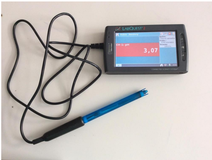
Obrázok 3: Ukážka zapojenia senzora s meracou interfejsovou jednotkou
