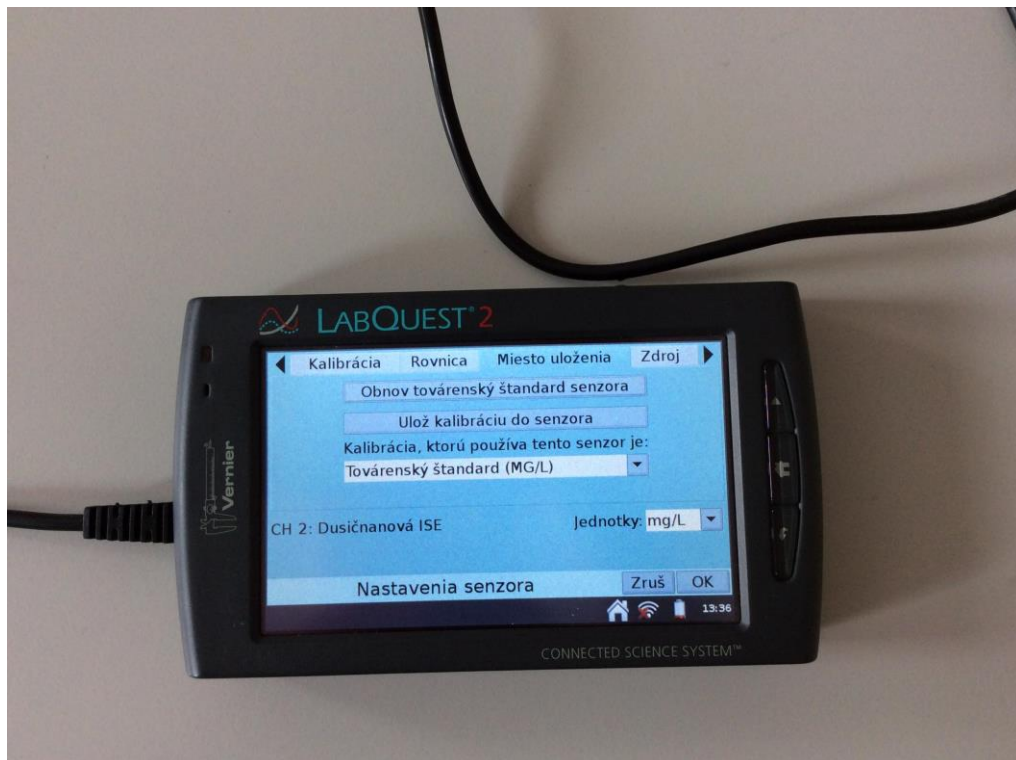
Obrázok 14: Ukončenie kalibrácie dusičnavej ISE
