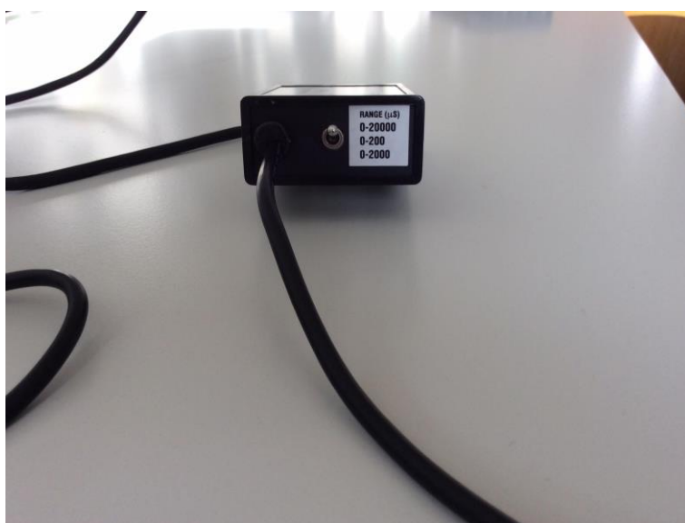
Obrázok 4: Prepínač meracích rozsahov- používame ho iba pri kalibrácii
